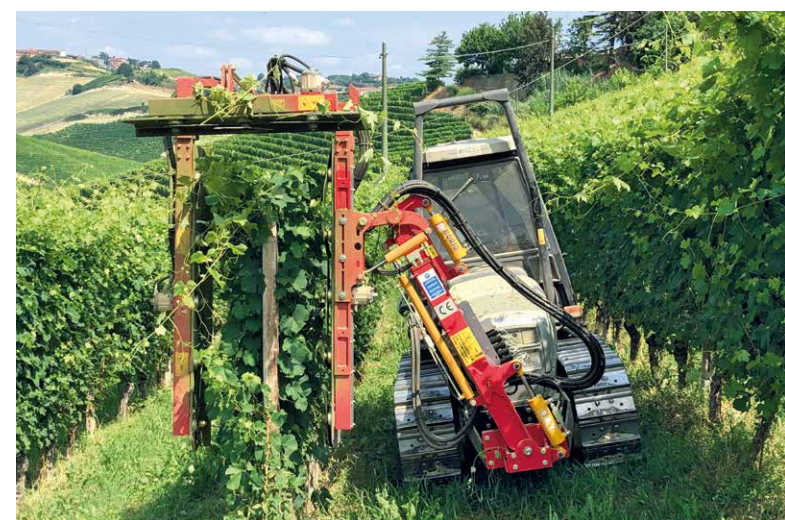
VERSIONE CON PISTONE PER RETRAIBILITÀ BARRA VERTICALE PIÙ ESTERNA (0-90°) + MOLLA DI SICUREZZA ANTIURTO.
